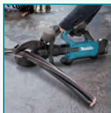
Per il taglio di cavi elettrici di grande diametro
