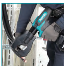
DTC303 - crimpatura senza matrice
