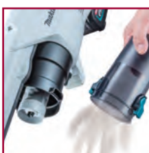
Svuotamento capsula senza rimozione sistema ciclonico
