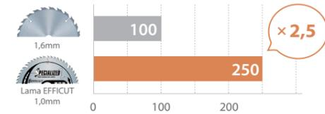
Le lame EFFICUT sono 2,5 volte più veloci rispetto alle lame per sega standard. Il nuovo design della punta riduce il contatto con il materiale, aumenta l'efficienza del rilascio degli scarti e ha un angolo di smusso più acuto. Ciò significa che i tagli sono più efficienti e la batteria dura 2,4 volte di più rispetto a una lama standard.
