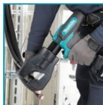
DTC303 - crimpatura senza matrice
