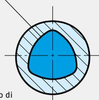
Diametro di serraggio poligonale
