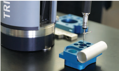
Non è più necessario portare i pezzi alla CMM, TRIMOS C4 può essere implementato direttamente in produzione. Il suo peso leggero di 13,5kg e l'impugnatura ergonomica consentono al C4 di essere facilmente spostato dove richiesto.
