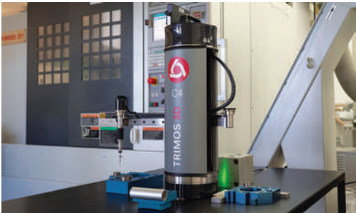
Il C4 ha 4 assi motorizzati (X, C, Z, P), permette misure ad alte prestazioni in 3D. Il suo speciale modulo di presa punto, dotato di stelo verticale e orizzontale, aumenta notevolmente le possibilità di misura.
