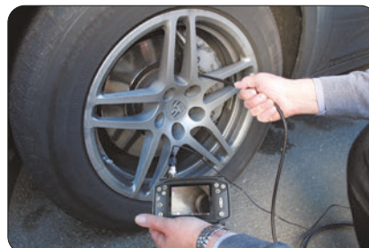
Esempio: Controllo delle pastiglie dei freni
