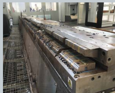
La completa sicurezza del sistema di tenuta magnetica è garantita dalla tecnologia elettropermanente SPD. A destra: profilo della rotaia da lavorare.
