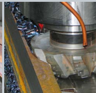
Fase di lavorazione della suola. A destra: seconda lavorazione del fungo. Operazione che richiede un bloccaggio sicuro.
