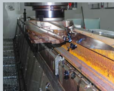
Prima lavorazione del fungo della rotaia. A destra: profilo di una rotaia lavorato in un solo posizionamento.
