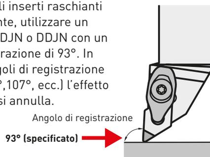
Mostra una grande efficienza del tratto raschiante durante la lavorazione della superficie frontale e del diametro esterno sia nella lavorazione destrorsa che in quella sinistrorsa.
