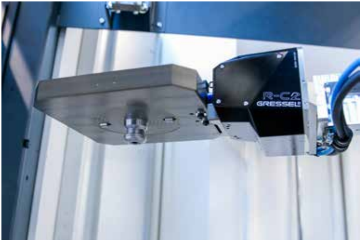
Parte inferiore del pallet con inserto in acciaio Pallets bottom with steel insert
