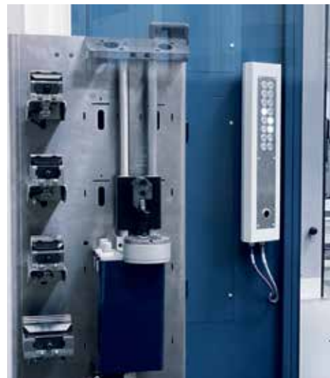
Integrazione con SCHUNK NSR-A 160 in automazione GROB Integration with SCHUNK NSR-A 160 in a GROB automation
