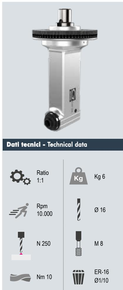
↻ Senso di rotazione Contrario al mandrino - Direction of rotation Opposite to the machine spindle
