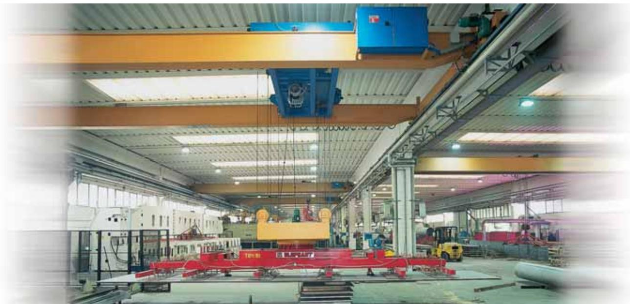
Ventosa tipo GLA18F a diciotto piastre - portata kg. 10.000 - rotazione mediante ralla.
