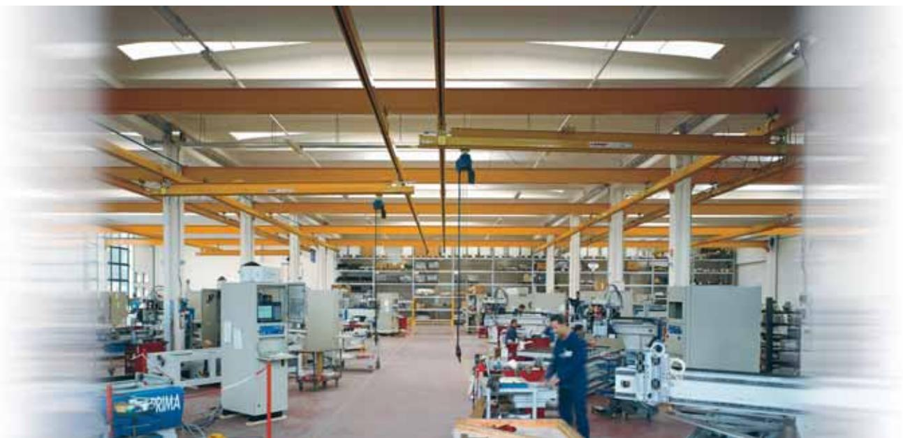
Impianti sospesi in canalina con traslazione manuale.
