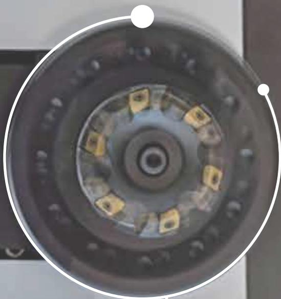
Elbo Controlli NIKKEN ha sviluppato un sistema che adatta la velocità periferica di rotazione dell'utensile in base al diametro massimo da misurare: la velocità periferica costante evita l'introduzione di errori, sia che si stia misurando un utensile di diametro 2 mm che uno da 200 mm.
