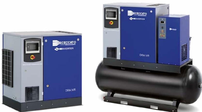
Il motore azionato da inverter adatta la velocità seguendo la richiesta di aria e, in abbinamento alla trasmissione diretta, consente un risparmio energetico fino al 35% rispetto a modelli a velocità fissa. I DRA 10-15 IVR PM montano un motore a magneti permanenti IE4 azionato
