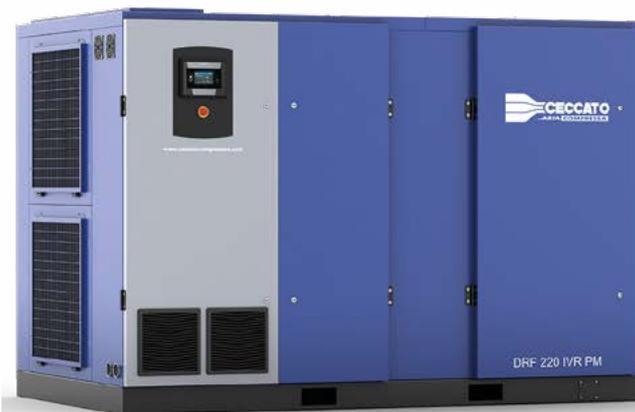
I DRF sono una famiglia completa che risponde alle esigenze della grande industria in cui è richiesta un'elevata portata d'aria, coniugando affidabilità e risparmio energetico. La trasmissione diretta permette di ridurre le perdite di energia e di ottenere un risparmio energetico e nella manutenzione. Nella versione IVR, il motore azionato da inverter adatta la velocità seguendo la richiesta di aria e, in abbinamento alla trasmissione diretta, consente un
