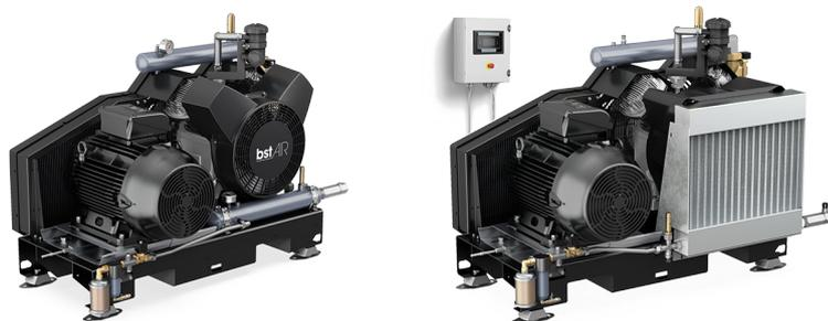
I booster sono compressori a pistone che prendono aria già compressa e la incrementa per raggiungere pressioni medie o elevate. Applicazioni come il taglio laser, la soffiatura di bottiglie PET e la formatura di plastica richiedono una pressione più elevata di quella che un compressore d'aria standard può fornire. Il compressore bstAIR può essere collegato con facilità alla rete di bassa pressione della fabbrica.
