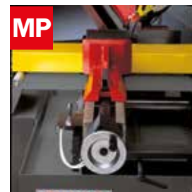
MORSA PNEUMATICA Pneumatic vice
