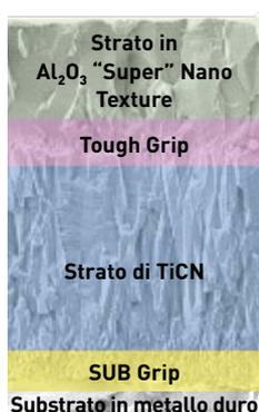
..... Strato in  $\text{Al}_2\text{O}_3$  con un'eccellente resistenza all'usura.
