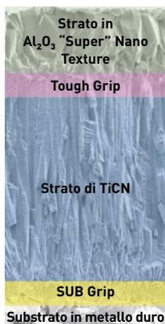
..... Strato in  $\text{Al}_2\text{O}_3$  con un'eccellente resistenza all'usura.
