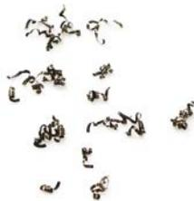
Con frequenza di vibrazione controllata = 1.25/giro
