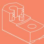
**Ganasce regolabili rigide, bloccaggio interno**
