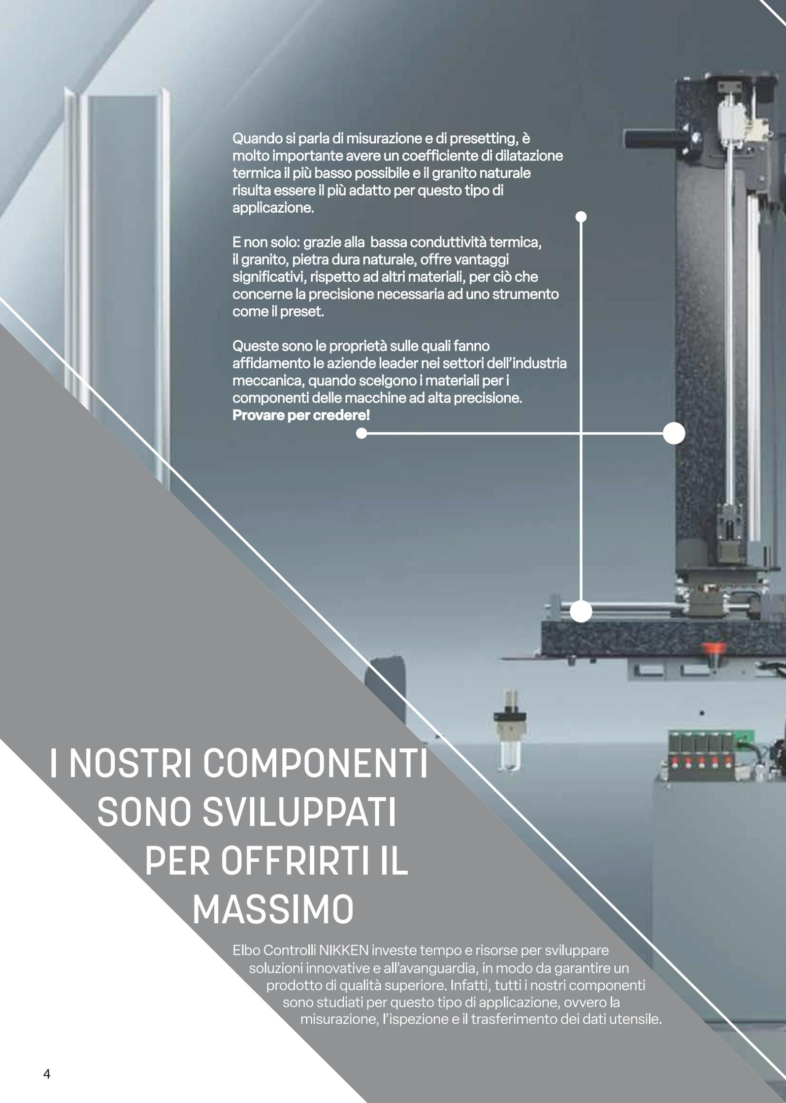
Quando si parla di misurazione e di presetting, è molto importante avere un coefficiente di dilatazione termica il più basso possibile e il granito naturale risulta essere il più adatto per questo tipo di applicazione.
